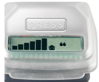
Displayanzeige wenn Sensor ganz nass misst (volle Balken)
